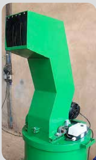
Figura 9 – Triturador de vidros 8
