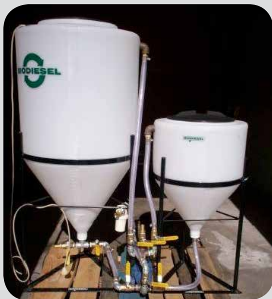
Figura 5 6 – Ilustração de miniusina de produção de biodiesel
